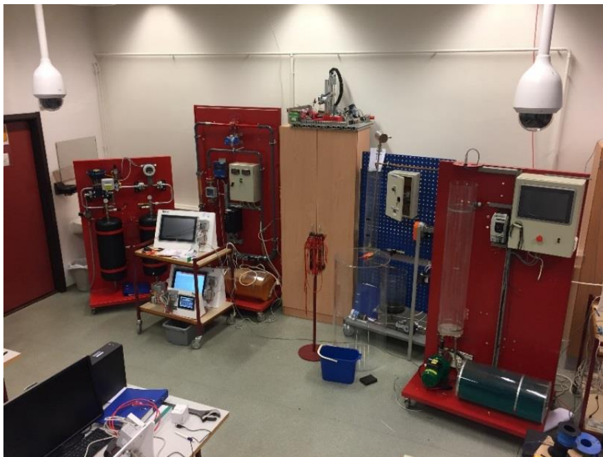
Fra laboratorium. Kamera med fjernbetjent panorering og zoom, forsøksrigger med instrumentering og mulighet for fjernstyring
